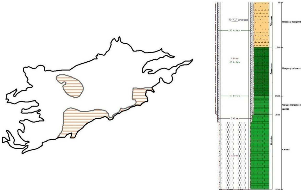
Figura nº 233.- Zona de inyección de salmueras o excedentes de EDAR. Captación tipo (DPA, 2007)
